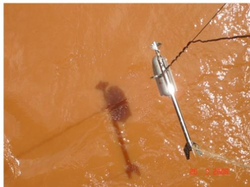
Figura 4: Molinete Fluviométrico com Lastro.
