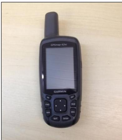
**Figura 5:** GPSmap 62sc portátil Garmin.
